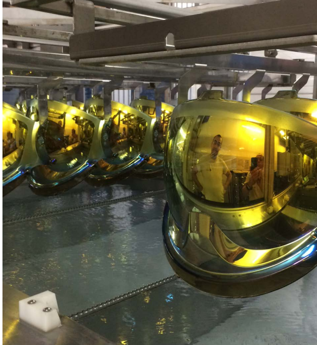
Dépôt à la chaîne de différents vernis sur des visières en polymère
